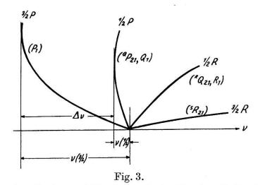
Bezeichnung der Zweige und Kantenabstände für eine Dublettkomponente eines Übergangs  ${}^2X\left(b\right) \to {}^2\Pi\left(a\right)$ . In Klammern stehen die Zweige für die Komponente mit  ${}^2\Pi_{1/2}$ .
