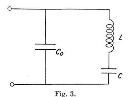
Circuit électrique équivalent d'un quartz.
