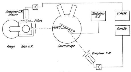
Fig. 2. Plan général de l'installation.
