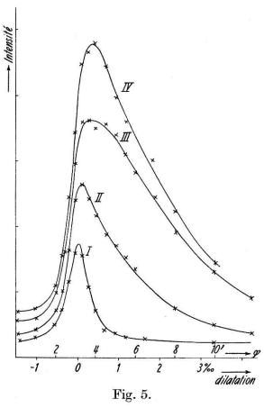
Mo  $K_{\alpha_1}$ , 2e ordre, sur quartz inerte (I) et oscillant (II, III, IV).
