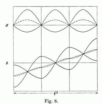
Nous avons représenté (fig.8a) les déformations locales (proportionnelles aux tensions) d'une lame vibrant à la troisième harmonique de sa fréquence de résonance, en portant positivement les dilatations et négativement les compressions.
