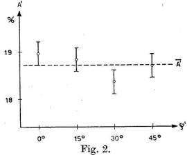
Resultat einer Messung der R. K. der Kaskade des Cd<sup>111</sup> in einem Silber-Einkristall. Aufgetragen ist die Anisotropie (ohne Raumwinkelkorrektur) gegenüber  $\varphi' = n \cdot \pi/2 + \varphi$ .
