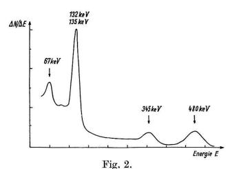
Szintillationsspektrum von  $\mathrm{Hf^{181}}-\mathrm{Ta^{181}}$  mit Absorber 0,3 mm  $\mathrm{Sn}+0,1$  mm Cu.
