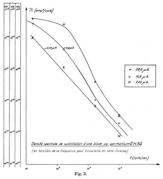
A la fréquence inférieure de 1700 c/sec, nous notons une légère déformation de la courbe accompagnée d'une faible augmentation de la pente vers les petits courants.
