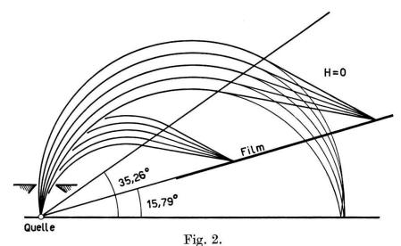
Fokussierung zweiter Ordnung in  $\varphi$  ( $R=\infty$ ) für Elektronen verschiedener Energie. Schwach gezeichnete Bahnen: lineare Fokussierung des Halbkreisspektrographen.
