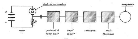
Fig. 1. Schéma de l'installation de mesure de bruit.
