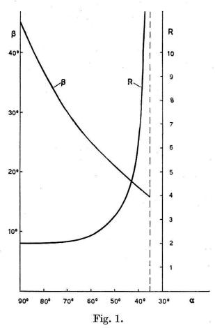
Bahnradien im zweiten Feldbereich und Neigungswinkel der Filmebene gegenüber der x-Achse für Fokussierung zweiter Ordnung in  $\varphi$ .
