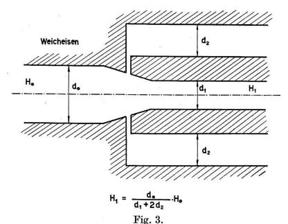
Anordnung der Polplatten beim Übergang zwischen den beiden Feldern (schematisch).
