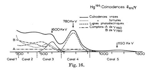
Notons encore que le taux de coïncidences dans le canal 4 du spectrographe  $\gamma$ , où nous avons placé la ligne photoélectrique du  $\gamma_{780}$ , est plus élevé que dans le canal 5 qui contient toute la partie du spectre d'énergie supérieure à 920 KeV; ceci indique que certains  $\gamma$  d'énergie supérieure à 920 KeV ne sont pas en coïncidence avec  $e_{61}$  L. Nous proposerons plus loin une explication de ce fait.
