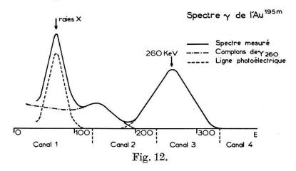
Le spectre non converti (fig. 12) est formé de la seule ligne  $\gamma$  de 261 KeV (photopic et fond Compton) et des rayons X provenant de sa conversion K.
