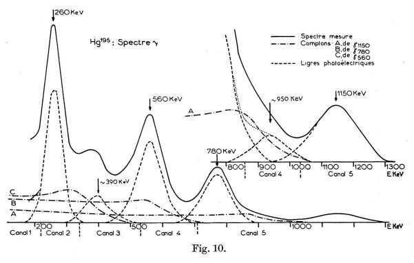
d'énergie inférieure à la limite de la portion de spectre considérée. Outre les lignes immédiatement apparentes de 1150 KeV, 780 KeV, 560 KeV et 260 KeV, l'analyse de ce spectrogramme met en évidence deux autres lignes à  $950 \pm 50$  KeV et  $390 \pm 50$  KeV.
