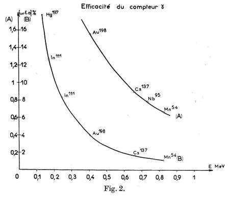
source placée à 11,3 mm du cristal (L=2,5 cm;  $\varnothing=3,2$  cm) et sans interposer d'absorbant autre que la boîte renfermant le cristal (soit: 1,8 mm d'Al + 2,5 mm de MgO). Lorsque l'on étudie des rayons  $\gamma$  de quelques centaines de KeV, il est parfois nécessaire d'absorber les rayonnements  $\gamma$  d'énergie faible (en particulier les
