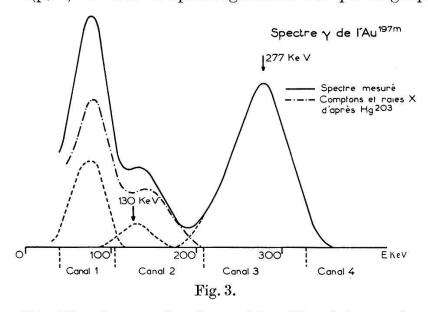
la source d'Au<sup>197m</sup> obtenu (fig. 3), on identifie aisément le photopic de la ligne γ de 277 KeV mais, pour une analyse complète, il est nécessaire de déterminer le fond Compton de ce rayonnement: nous l'avons calibré expérimentalement à l'aide du rayonnement
