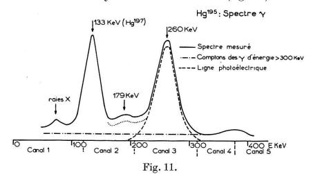
Ces spectrogrammes montrent que seule est possible l'étude des raies  $\gamma$  d'énergie supérieure ou égale à 261 KeV; pour les transitions d'énergie inférieure, la perturbation, qu'introduit la présence des rayons X et des lignes relativement peu converties du Hg<sup>197</sup> ( $\gamma_{133}$  et  $\gamma_{77}$ ), rend illusoire toute détermination d'intensité. Les intensités, résultant de l'analyse des spectres  $\gamma$ , figurent dans le tableau 4;
