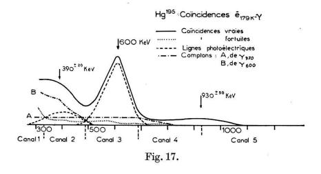
2. Coïncidences  $e_{179K}^- - \gamma$ . Le spectre des coïncidences  $e_{179K}^- - \gamma$  (fig. 17) a été mesuré dans des conditions identiques à celles de la mesure de coïncidences  $e_{61L}^- - \gamma$  précédente: le spectre  $\gamma$  de la source est donc celui de la figure 15. L'analyse montre que la ligne  $e_{179K}^-$  est en coïncidence avec des lignes  $\gamma$  d'énergie 600 KeV,
