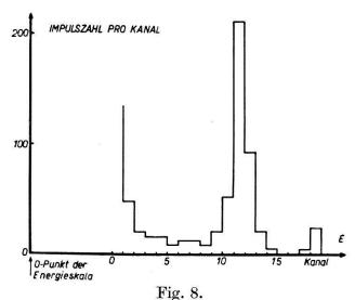
Impulsspektrogramm der O $^{16}$ (n,  $\alpha$ )C $^{13}$ -Reaktion bei  $E_n=4,11$  MeV.
