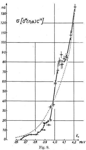
Wirkungsquerschnitt für die  $O^{16}(n, \alpha)C^{13}$ -Reaktion.
