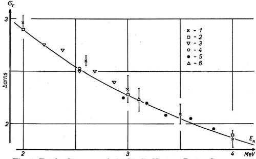
Fig. 5. Totaler Streuquerschnitt für die Neutron-Proton-Streuung.
