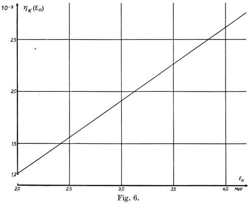
Wirkungsgrad  $\eta_K$  der Protonrückstoss-Kammer.
