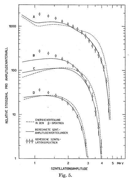
Vergleich der  $\beta$ -Energien von Cl<sup>38</sup> (Kurven A) und Na<sup>25</sup> (B Einzelspektrum, D globales Koinzidenz-Beta-Spektrum) mit Berücksichtigung der Reichweiteverluste.
