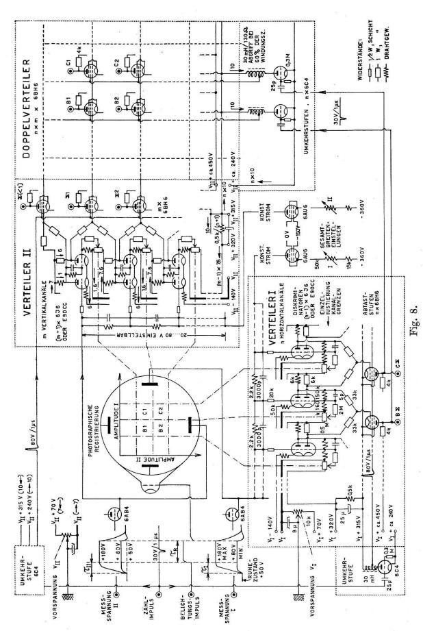
Prinzipschema der Zählkanäle, Anordnung für Koinzidenzmessungen mit doppelter Energieverteilung. Widerstandswerte in k\O bzw. MQ, Kapazitätswerte in pF bzw.  $\mu F$ . Pfeile mit Zahlen bedeuten Ströme in mA.
