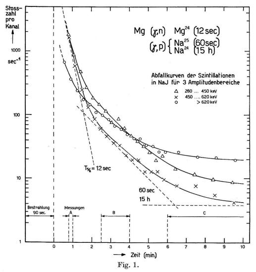
Zeitlicher Verlauf der in Mg durch Bestrahlung im Betatron erzeugten Aktivitäten in verschiedenen Energiebereichen des  $\gamma$ -Spektrums.
