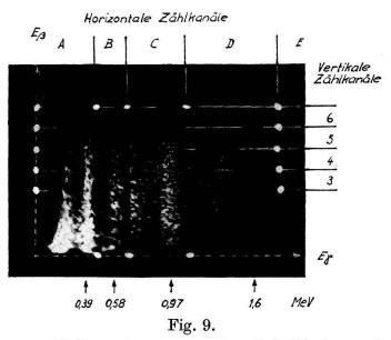
$\beta\gamma$ -Koinzidenzen von Na $^{25}$ , aufgenommen im Szintillationsspektrographen mit doppelter Energieverteilung. Einige Kanalgrenzen-Kreuzungspunkte sind mittels Eichimpulsen markiert. Im Gebiet der Horizontalkanäle A und B wurde die Platte nur bei einem Drittel der Messungen belichtet.
