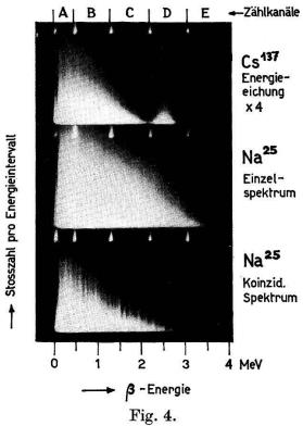
$\beta\text{-Szintillations$  $spektren von Na<math display="inline">^{25}$  und Cs $^{137}.$
