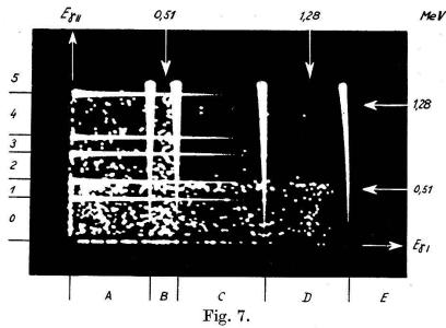
Kombination von photographischer und Zählwerk-Registrierung bei Koinzidenzmessungen mit doppelter Energieverteilung. Die horizontalen und vertikalen Linien zeigen die Lage der Zählkanäle an (Einstellungen für  $\gamma\gamma$ -Koinzidenzen von Na<sup>22</sup>).
