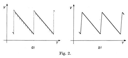
a) Onde cathodique; b) Onde sur le condensateur d'accumulation.
