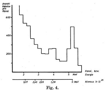
Spektrogramm einer Messung mit kleinem Sättigungsdefizit, aber grossem Randeffekt.  $E_n=3.76~{\rm MeV}.$
