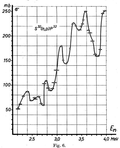
Reaktionsquerschnitt von S<sup>32</sup>(n,p)P<sup>32</sup>.
