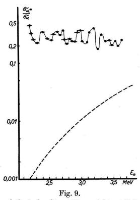
— Verzweigungsverhältnis der  $S(n,\alpha)Si^*$ - und  $S(n,\alpha)Si$ -Reaktion als Funktion der Neutronenergie  $E_n$ .
