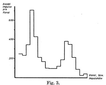
Spektrogramm einer Messung für den Punkt  $E_n=2.74\pm0.04$  MeV.
