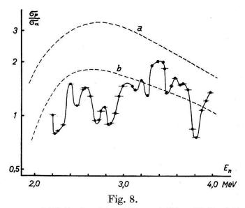
— Verzweigungsverhältnis der  $S(n,\alpha)Si$ - und S(n,p)P-Reaktion als Funktion der Neutronenenergie  $E_n$  (— Messpunkte mit berechnetem Auflösevermögen).
