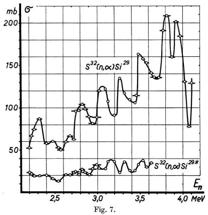
Reaktionsquerschnitte von  $S^{32}(n,\alpha)Si^{29}$  und  $S^{32}(n,\alpha)Si^{29*}$ .
