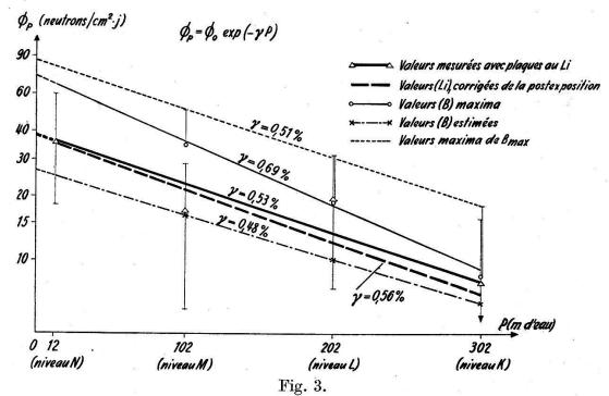
Flux de neutrons thermiques dans l'eau, produits par la radiation cosmique, à différentes profondeurs.
