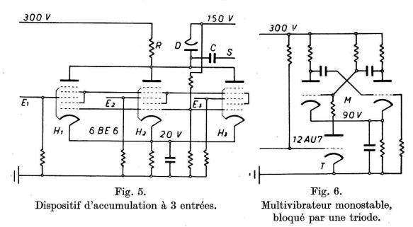
circuits préamplificateurs n'est pas inférieur à  $0,1~\mu$  sec, la résolution de groupes de plus de trois impulsions est inutile. Dans la plupart des cas, la résolution des groupes de deux impulsions suffit amplement ce qui permet de se dispenser de l'amplificateur différentiel.
