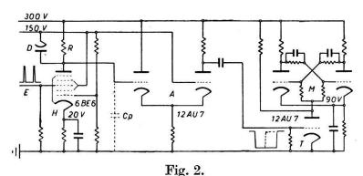
Circuit avec amplificateur différentiel.
