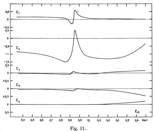
Legendresche Entwicklungskoeffizierten  $C_L$  der differentiellen Polarisation an  $C^{12}$ , berechnet aus den Streuphasen Fig. 7.
