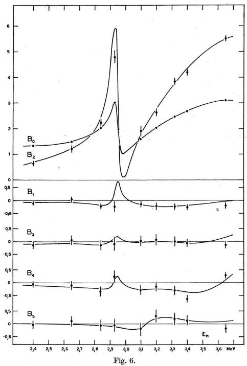
Legendresche Entwicklungskoeffizienten  $B_L$  für die elastische Streuung von Neutronen an  ${\bf C}^{12}$ . Die ausgezogenen Kurven sind mit angepassten Streuphasen berechnet.
