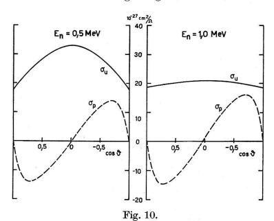
Mutmasslicher Verlauf des differentiellen Wirkungsquerschnittes  $\sigma_u$  und der Polarisation  $\sigma_n$  bei 0,5 und 1,0 MeV.
