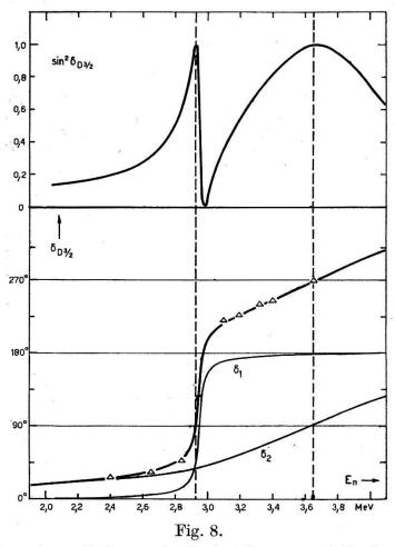
Phasenverlauf von  $\delta_{d3/2}$ . Zerlegung in die Anteile von zwei überlappenden Einzelresonanzen. Darüber: Darstellung der Interferenzerscheinung im totalen Wirkungsquerschnitt ohne die Beiträge der s- und p-Streuung.
