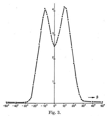
Neutronenprofil des Kollimators bei zentrierter Lage des Streukörpers.
