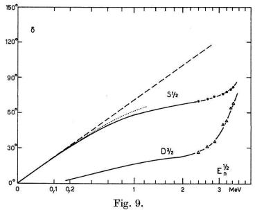
Mutmasslicher Verlauf der s 1/2 und d 3/2-Phasen bei kleinen Energien. s 1/2: Interpolation zwischen den Werten von Thomas<sup>29</sup>) (punktiert) und unserer Phasenanalyse.
