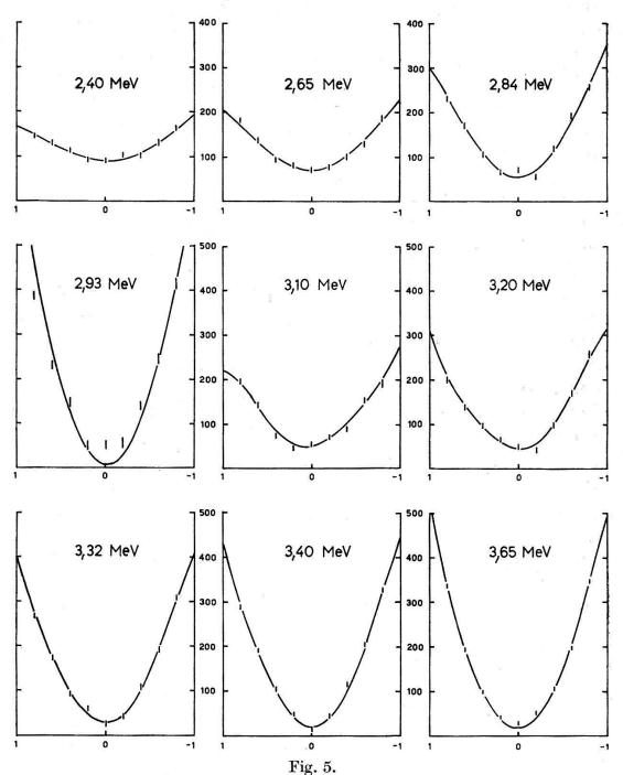
Differentieller Wirkungsquerschnitt  $\sigma$  (cos  $\vartheta$ ) elastisch gestreuter Neutronen an  $C^{12}$  in mb pro Raumwinkeleinheit. Die Messpunkte sind für Geometrie und Mehrfachstreuung korrigiert. Die ausgezogenen Kurven sind mit angepassten Streuphasen berechnet.
