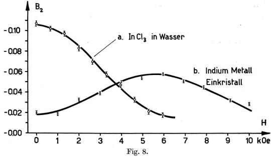
Resultate der Messungen im Magnetfeld. a) Flüssige Quelle (InCl<sub>3</sub> in H<sub>2</sub>O). b) Indium-Einkristall mit kombinierter elektrischer und magnetischer Wechselwirkung.
