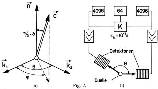
a) Allgemeine Anordnung für axialsymmetrische Felder mit der Symmetrieachse  $\vec{c}$ .  $\vec{k_1}$  und  $\vec{k_2}$  sind die Richtungen des ersten und zweiten Quants,  $\vec{n}$  ist die Normale zur Zählerebene. b) Blockschema der  $(\gamma - \gamma)$  R.K.-Apparatur.
