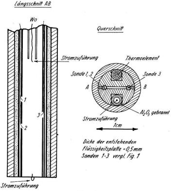
Fig. 2. Schnitte durch das Meßsystem.
