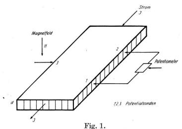
Anordnung der Elektroden.
