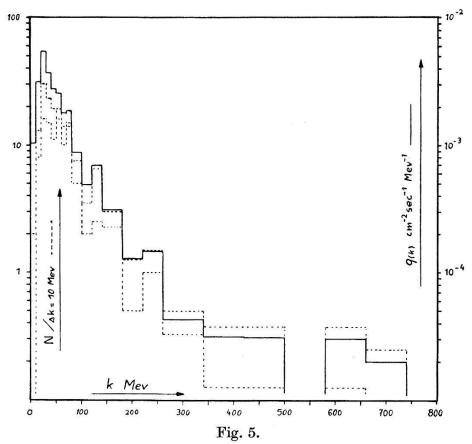
Das Spektrum der  $\gamma$ -Strahlung auf dem Monte Rosa. Das untere punktierte Histogramm zeigt die Häufigkeitsverteilung der Paare, deren Energie aus der Vielfachstreuung bestimmt wurde, das obere punktierte Histogramm umfasst dazu noch diejenigen Paare, deren Energie aus dem Divergenzwinkel abgeschätzt wurde. Das ausgezogene Histogramm zeigt den aus der Paarhäufigkeit berechneten Fluss der Photonen.
