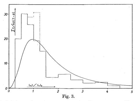
Die Häufigkeitsverteilung der Paare über  $\omega/\omega_0$ . Das ausgezogene Histogramm umfasst die Paare mit a > 0.1, die punktierte Linie zeigt das Histogramm aller Paare, an denen  $\omega$  und k gemessen wurden. Die theoretische Kurve ist die Wahrscheinlichkeitsverteilung nach Borsellino.
