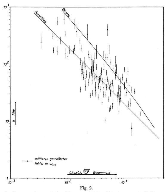
Der Zusammenhang zwischen Divergenzwinkel und Photonenenergie k. Die experimentellen Werte sind die für symmetrische Energieaufteilung reduzierten Winkelwerte  $\omega_{\rm red}$ . Die Kurven sind der warscheinlichste Divergenzwinkel  $\omega_p$  nach Borsellino und die Wurzel aus dem mittleren Quadrat  $\sqrt{\overline{\omega}^2}$  nach Stearns.
