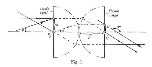
Ce modèle iconal est celui d'un instrument idéal pour l'établissement des cartes stellaires. Il présente aussi un intérêt en photographie, comme modèle de télé-objectif et aussi pour la prise de vues et la projection avec la même optique.
