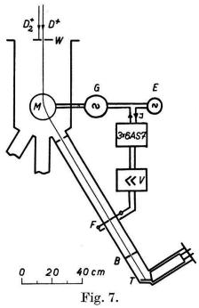
Blendensystem im Targetrohr.
