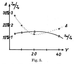
Untergrund als Funktion der Zählerdiskriminierung. Die ausgezogene Kurve stellt  $J_m/J_0$  dar, die gestrichelte den statistischen Fehler  $\Delta$  von  $J_m-J_0$  für eine dreiminütige Messung bei  $E_d=600~{\rm keV}$  und 150  $\mu A$   $D^+$ .
