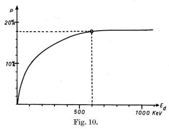
Berechnete Änderung des Polarisationsgrades mit der Deuteronenenergie. Eichung der Ordinate durch Anschluss an die Experimente.
