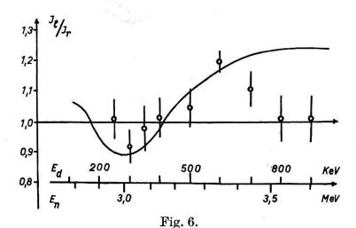
Verhältnis der Streuintensitäten bei den Zählerstellungen links bzw. rechts in Funktion der Deuteronenergie  $E_d$  oder Neutronenergie  $E_n$  (Angaben im Lab.-System). Die ausgezogene Kurve ist mit dem variablen Polarisationsgrad von Fig. 8 auf Grund der Phasenanalyse berechnet.
