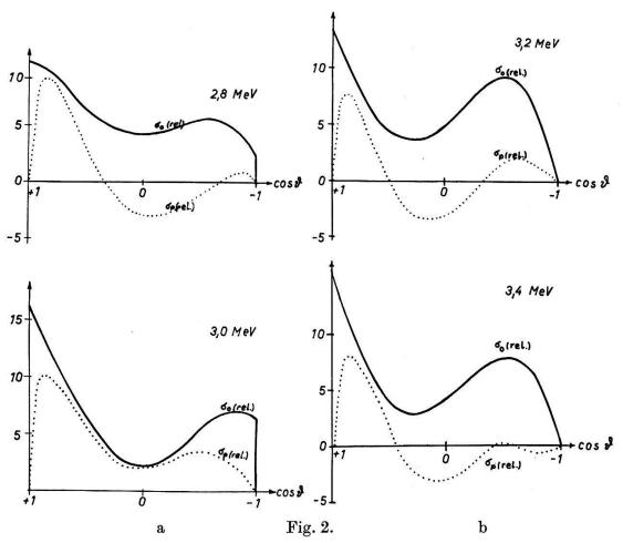
Relative Anteile der differentiellen Streuquerschnitte  $\sigma_0$  und  $\sigma_p$  für Kohlenstoff. Die ausgezogenen Kurven stellen den relativen Streuquerschnitt  $\sigma_0$  für unpolarisierte Neutronen dar, während die gestrichelten Kurven relative Werte von  $\sigma_p$  für  $\varphi = 90^{\circ}$  angeben. ( $E_n =$  Neutronenenergie im Lab. System;  $\vartheta =$  Streuwinkel im Schwerpunktsystem.)
