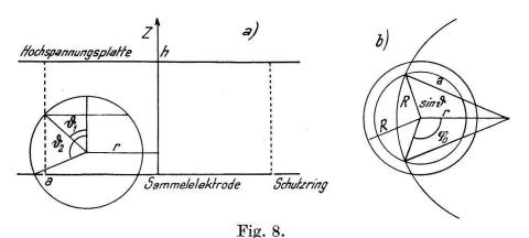
Zur Berechnung von  $\varrho$  und  $\varrho^*$ : a) Seitenriss und b) Grundriss des Zählvolumens.
