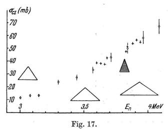
Wirkungsquerschnitt der  $Cl^{35}$  (n,  $\alpha$ )-Reaktion in Abhängigkeit von der Neutronenenergie. Das schraffierte Dreieck gilt für die Kreuze, die mit einer dünnen Target gemessen sind.
