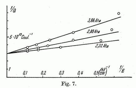
Sättigungskurven von Chlor. Parameter ist der Fülldruck.
