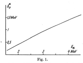
Energiedifferenz zwischen  $\alpha$ -Teilchen und Protonen als Funktion der Energie;  $R_{\alpha}=5.0$  mm; grösste Ausdehnung des Zählvolumens 2,24 cm.
