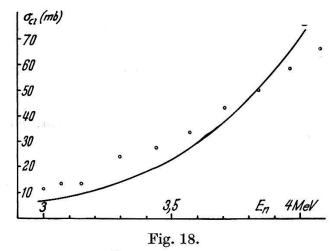
Vergleich der Funktion  $e^{-G}$  mit dem gemessenen Wirkungsquerschnitt.
