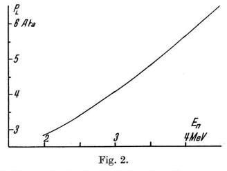
Kammerdruck (Luftäquivalent) als Funktion der Neutronenenergie  $Q(n, \alpha) = 1,00$  MeV.  $R_{\alpha} = 5,0$  mm (Mittelwert zwischen maximaler und minimaler Reichweite der  $\alpha$ -Teilchen).
