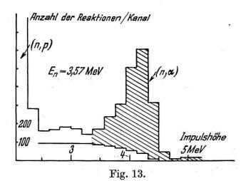
Aufnahme zur Bestimmung des relativen Wirkungsquerschnittes.
