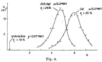
Comparaison des hauteurs d'impulsions des poudres de CsI (77° K) et de ZnS(Ag) avec excitation par les particules  $\alpha$  du Po.
