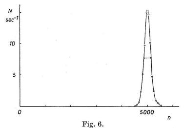
Spectre d'impulsions des scintillations  $\alpha$  dans le CsI (77° K) avec Po en surface. |----| Largeur à mi-hauteur calculée. Hauteur des impulsions exprimée par n; n = nombre de photo-électrons libérés sur la photocathode du tube multiplicateur.
