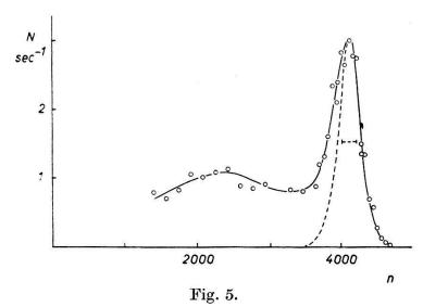
Spectre d'impulsions des scintillations a dans le CsI avec Po ingéré.
