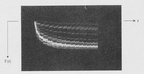
Fig. 1. Forme d'impulsion de scintillations  $\alpha$  dans le CsI. La distance entre deux marques de temps est de  $10^{-7}$  sec;  $\tau' = 0.34~\mu{\rm sec}$ .
