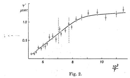
Temps de déclin  $\tau' = f(T)$  de la luminecence du CsI pour les particules  $\alpha$  du Po.  $\tau' =$  temps écoulé entre les moments où 10%, respectivement 90% des photons ont été émis (rise-time de l'impulsion de tension).
