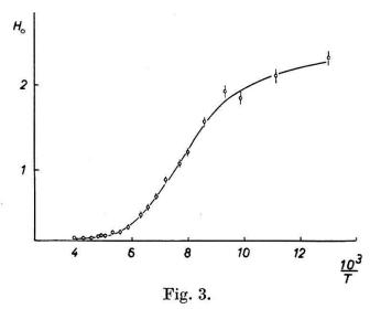
Hauteur  $H_0$  des impulsions de scintillations  $\alpha$  dans le CsI (Po ingéré) en fonction de la température.
