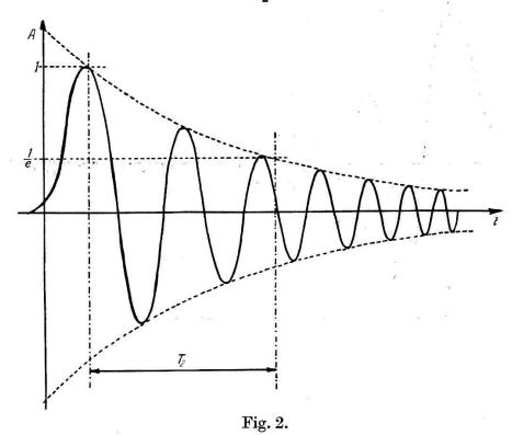
Exemple: Si le champ passe linéairement de  $H-\varDelta$  à  $H+\varDelta$  suivant une direction donnée dans l'échantillon, la distance en unité de temps  $T_3$  des deux premiers minima de l'enveloppe de la courbe obtenue permet de calculer  $\varDelta$
