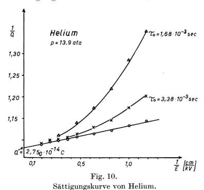
Reziproke Ladung (willkürliche Einheiten) in Abhängigkeit der reziproken Feldstärke. Die unkorrigierten Kurven sind ebenfalls eingezeichnet. Der Absolutwert der Sättigungsladung ist angegeben.
