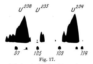
Aufnahme im Impulsspektrographen. Es sind  $1200~\alpha$ -Teilchen von natürlichem Uran registriert. Die Abszisse entspricht der Impulshöhe, die Ordinate dem Logarithmus der Impulszahl. Am untern Rand der Aufnahme sind Eichmarken angebracht, deren Ladung in willkürlichen Einheiten angegeben ist.
