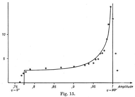
Einfluss der Ionenlaufzeit auf das Amplitudenspektrum. Die Figur zeigt das Amplitudenspektrum von Po- $\alpha$ -Teilchen bei Stickstoffüllung p=4,5 ata, Feldstärke 750 V/cm, Plattenabstand 1 cm, Zeitkonstante  $\tau_0=1,68\cdot 10^{-3}$  s. Die berechnete Verteilung ist eingezeichnet. Der Einfluss des Rauschens (70 keV) und der Rekombination (2% Defizit bei  $\varphi=90^{\circ}$ ) ist nicht berücksichtigt.
