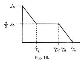
Ionisationskammerimpuls in einer Parallelplattenkammer bei gleicher Beweglichkeit der positiven und negativen Ionen und homogener Ionisierung längs der Spur. Die  $\alpha$ -Quelle soll sich auf der einen Elektrode befinden.
