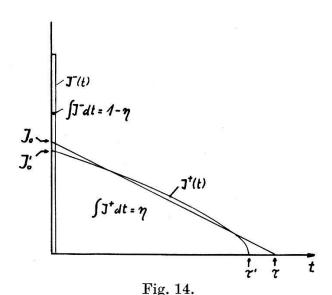
Stromverlauf in der Ionisationskammer.
