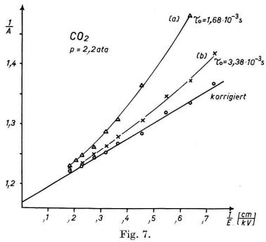
Einfluss des ballistischen Defizits auf die Messung einer Sättigungskurve. Es ist der reziproke Wert der Impulshöhe am Verstärkerausgang in Abhängigkeit der reziproken Feldstärke aufgetragen.
