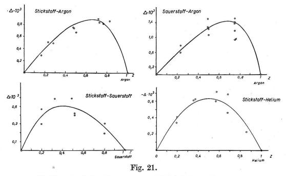
Einfluss der Sekundärprozesse auf die Arbeit pro Ionenpaar. z ist ein Mass für das Mischverhältnis (vgl. Formel 24), ⊿ ein Mass für die Abweichung vom Verhalten bei unabhängiger Ionisierung (vgl. Formel 25). Der Maßstab auf der Ordinate ist in Einheiten 1/Elektronvolt angegeben.
