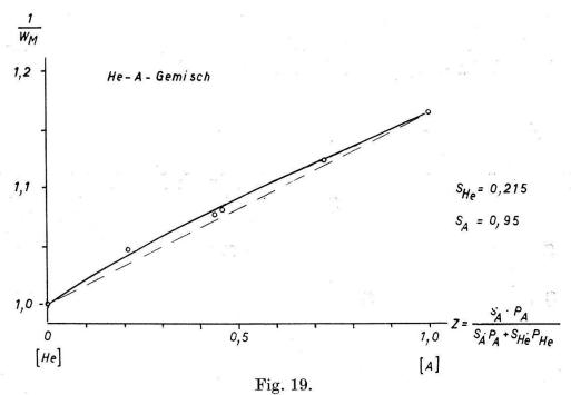
Arbeit pro Ionenpaar für He-A-Mischungen in Abhängigkeit vom Mischverhältnis. Es ist  $1/W_M$  als Funktion von  $z=s_Ap_A/s_Ap_A+s_{He}p_{He}$  aufgetragen.  $W_{He}$  ist auf eins normiert. Die Gerade entspricht dem Verlauf, den man bei unabhängiger Ionisierung der Komponenten erwarten würde.
