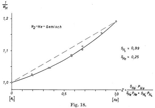
Arbeit pro Ionenpaar für  $N_2$ -He-Mischungen in Abhängigkeit vom Mischverhältnis. Es ist  $1/W_M$  als Funktion von  $z=s_{He}\,p_{He}/s_{He}\,p_{He}+s_{N_2}\,p_{N_2}$  aufgetragen.  $W_{N_2}$  ist auf eins normiert. Die Gerade entspricht dem Verlauf, den man bei unabhängiger Ionisierung der Komponenten erwarten würde.
