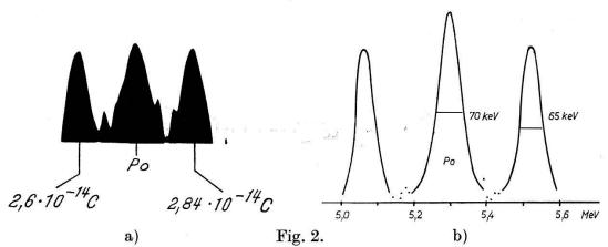
Impulsspektrum von Po-α-Teilchen im Vergleich mit Eichladungen. Heliumfüllung 14 ata, Feldstärke 4 kV/cm.
