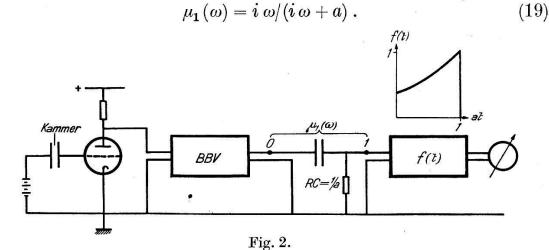
Übersicht über den optimalen Ionisationskammerverstärker.
