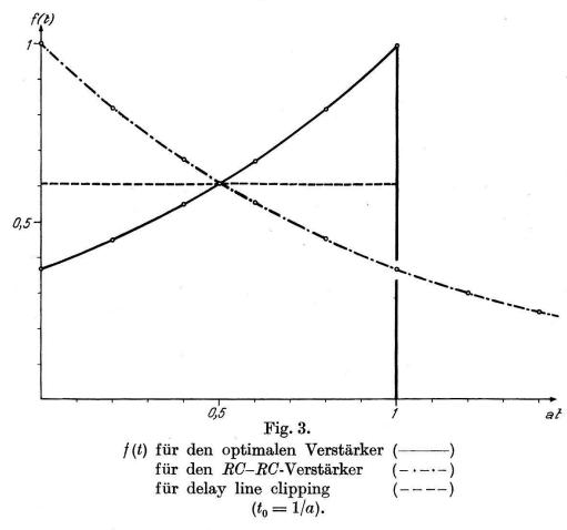
ist als der RC-RC-Verstärker. In seinen Betrachtungen über die prinzipielle Grenze der Messgenauigkeit, wenn Signal und Rauschen durch (17) und (18) gegeben sind, kommt van Heerden<sup>5</sup>) zu dem gleichen Resultat. Schreibt man für den optimalen Verstärker die gleiche Messzeit  $t_0 = 1/a$  vor, wie sie der beste RC-RC-Verstärker hat, so ist der Gewinn im Verhältnis von Signal zu Untergrund nur noch 26%. Da das die tiefen Frequenzen beschneidende RC-Glied
