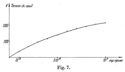
Elévation du seuil avec l'usure du compteur.
