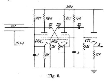
Deux causes peuvent expliquer la réduction de pente qui, pour une résistance anodique de 1 M, caractérise l'élévation du taux de comptage.
