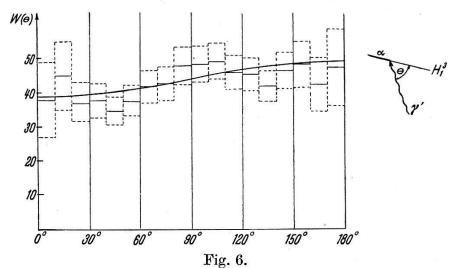
$\text{Li}_{\frac{3}{8}}(\gamma,\alpha)$   $\text{H}_{\frac{3}{4}}$ : Winkelverteilung  $W(\Theta)$  auf Grund von 380 Spuren.
