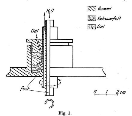
Rotierende, wassergekühlte Target mit Detailzeichnung der Durchführung.
