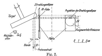
Anordnung der Platten bei Bestrahlung zur Bestimmung des Wirkungsquerschnittes.
