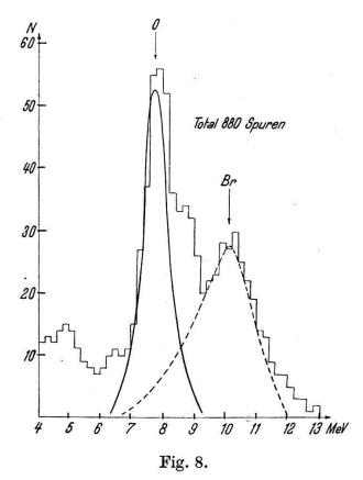
$\alpha$ -Spuren aus einer mit Li(p,  $\alpha$ )-Strahlen bestrahlten Kernphotoplatte.
