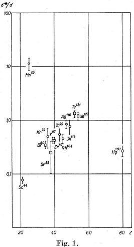
Relative Wirkungsquerschnitte für die Anregung von Isomeren- und Grundzuständen durch die (pn)-Reaktion mit 6,7 MeV Protonen.
