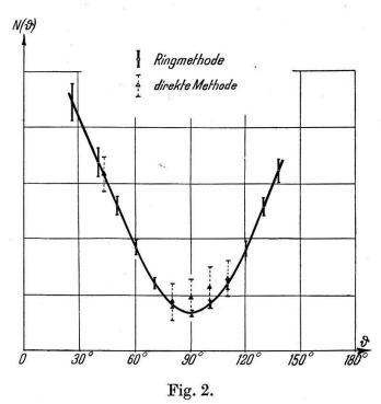
Intensität der an C<sup>12</sup> gestreuten 3,62-MeV-Neutronen in Funktion des Winkels (Schwerpunktsystem).
