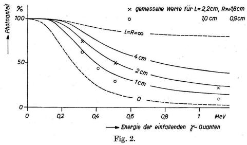
Theoretisches Verhältnis der Photospitze zum Gesamteffekt für zylindrische Na<br/>I-Kristalle (Länge  $L={\rm Radius}\ R$ ) bei Einstrahlung in der Zylinderachse.
