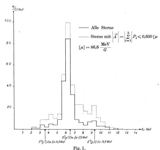
$E_T$ -Verteilung von 374 Sternen. Die Energie der einfach geladenen Teilchen wird mit Hilfe der Reichweite-Energie-Beziehung für Tritonen berechnet.
