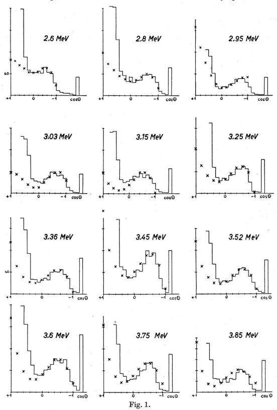
Differentieller Wirkungsquerschnitt für die Neutronen-Streuung an C<sup>12</sup>. Als Abszisse ist der Kosinus des Streuwinkels vom Neutron im Schwerpunktssystem, als Ordinate die Impulszahl/Kanal aufgetragen. Die Einheit in der Ordinate entspricht 160 Impulsen/Kanal.
