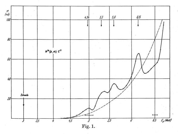
Reaktionen  $(p,\gamma)$  (p,n) (p,p)  $(p,\alpha)$  treten nur die beiden letzten in Konkurrenz, weil die (p,n)-Schwelle über der Maximalenergie liegt und der  $(p,\gamma)$ -Prozess gegenüber Reaktionen mit Teilchenemission ganz zurücktritt. Der Verlauf der Kurve zeigt verhältnismässig schwach ausgeprägten Resonanzcharakter, was vermuten lässt, dass wir uns in einem Gebiet relativ grosser Niveaudichten und be-
