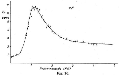
Totaler Querschnitt für die (n-He<sup>4</sup>)-Streuung nach Bashkin u. a. Die Kreuze (x) geben die aus den Phasen (Fig. 17) berechneten Werte.
