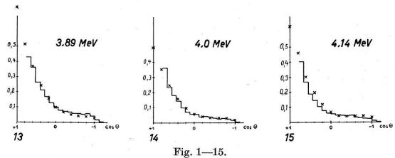
Relative differentielle Querschnitte für die n-He<sup>4</sup>-Streuung. Die in Fig. 1—8 dargestellten Messwerte  $(\cdot)$  sind von Adair, die Stufenkurven von uns gemessen. Die Kreuze geben die aus den Phasen berechneten Werte. Als Abszisse ist der Cosinus des Streuwinkels  $\Theta$ , als Ordinate ein rel. Mass des differentiellen Querschnittes aufgetragen.
