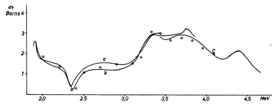
Fig. 1. Totaler Wirkungsquerschnitt von O<sup>16</sup> von 2,0 bis 4,5 MeV.
