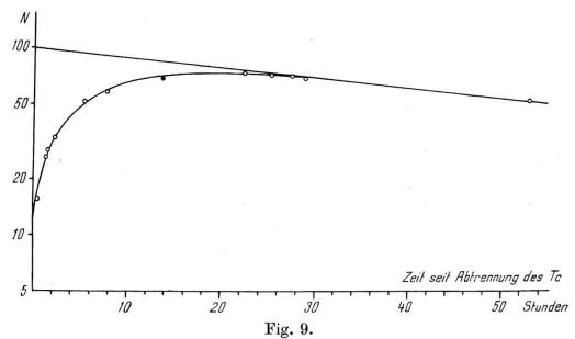
Zeitlicher Verlauf der Intensität der 141 keV-γ-Strahlung nach Abtrennung des Tc-Isomers.
