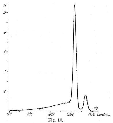
Konversionslinien des 141,2-keV-Überganges (abgetrenntes  $\mathrm{Te}^{99}$ ) Messung im Linsenspektrometer, Stosszahl nicht durch  $H\varrho$  dividiert.
