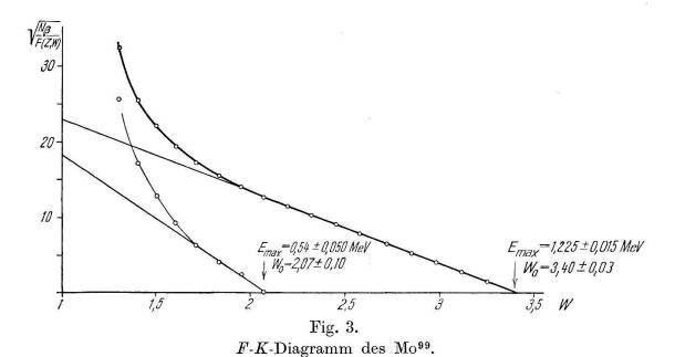
Messung wurde mit einem Aluminiumzählrohr von 0,2 mm Wandstärke durchgeführt, dessen Innenwand mit einer 40  $\mu$  dicken Goldschicht ausgekleidet war. Durch Kohleabsorber wurde die harte  $\beta$ -Strahlung vom Zählrohr ferngehalten. Aus der bekannten Sensibilität kann die Intensität der beiden stärksten Komponenten
