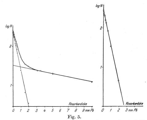
Absorption der  $\gamma$ -Strahlung in Blei des Mo<sup>99</sup> im Gleichgewicht mit Tc<sup>99\*</sup> (links) und des abgetrennten Tc<sup>99\*</sup>.
