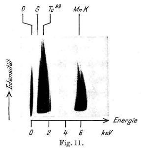
Impulsspektrogramm der Tc<sup>99\*</sup>-Strahlung.
