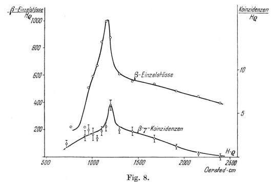
$\beta\text{-}\gamma\text{-}\mathrm{Koinzidenzen}$ im Linsenspektrometer.
