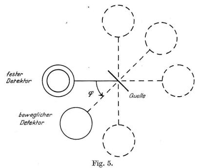
Grundriss einer experimentellen Anordnung mit flächenhaft ausgedehnter Quelle.
