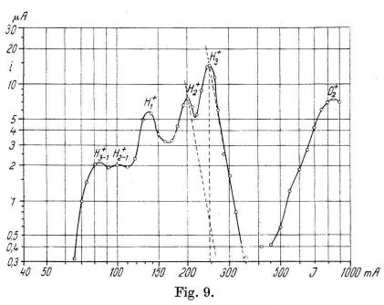
Spectre de masse de l'hydrogène.
