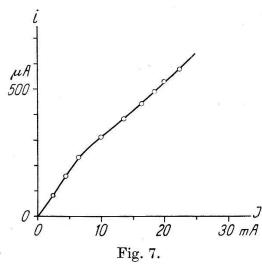
Courant ionique en fonction du courant de décharge.
