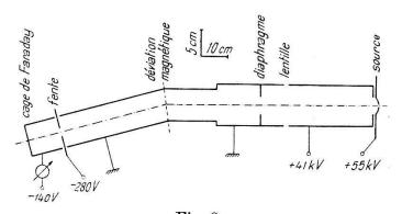
Fig. 8. Spectrographe de masse.
