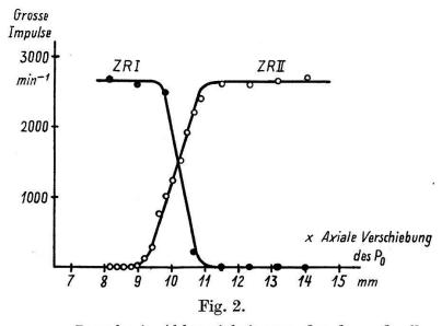
Die Zahl der grossen Impulse in Abhängigkeit vom Ort der  $\alpha$ -Quelle nach Fig. 1. ZR I und ZR II sind die Messkurven der entsprechenden Zählrohrabschnitte.
