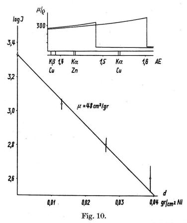
Absorption der Röntgenstrahlung des Zn<sup>63</sup>. (Nickel-Absorber.)
