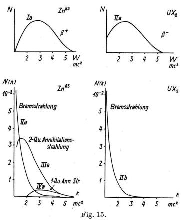
Sekundär-γ-Strahlung des Zn<sup>63</sup> und UX<sub>2</sub>.
