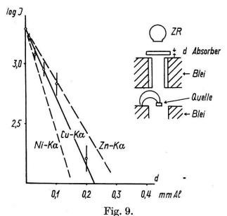
Absorption der Röntgenstrahlung des Zn<sup>63</sup>. (Al-Absorber.)
