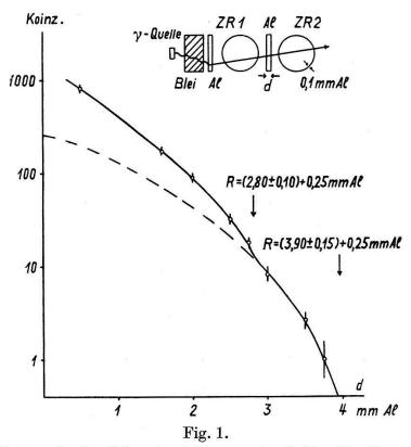
Reichweite der Sekundärelektronen der Zn<sup>63</sup>-y-Strahlung.
