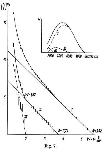
Fermi-Diagramm des Positronenspektrums des Zn<sup>63</sup>.
