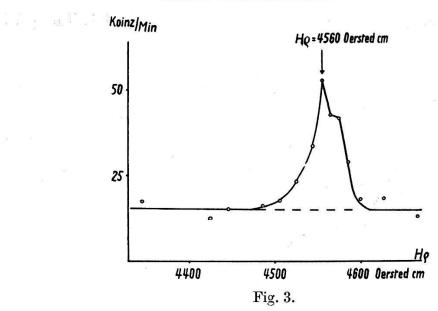
Konversionslinie der 0,960 MeV  $\gamma$ -Strahlung.
