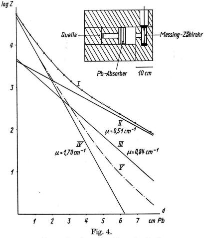
Absorption der  $\gamma$ -Strahlung des Zn<sup>63</sup>. (Detektor der  $\gamma$ -Strahlung: Zählrohr mit Messingkathode.)
