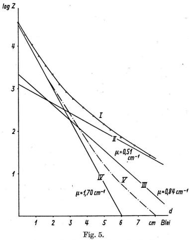
Absorption der  $\gamma$ -Strahlung des Zn<sup>63</sup>. (Detektor der  $\gamma$ -Strahlung: Zählrohr mit Bleikathode.)
