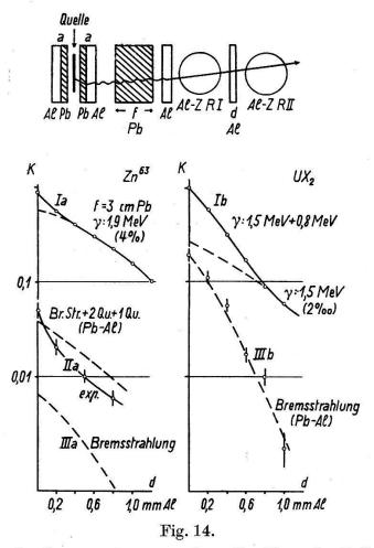
Absorption der Comptonelektronen der  $\gamma$ -Strahlung des Zn<sup>63</sup> und UX<sub>2</sub>.
