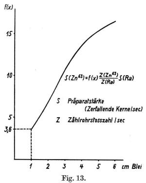
Vergleich der Zählrohrstosszahlen von Zn<sup>63</sup>- und Radium-Präparaten. (Messingzählrohre.)
