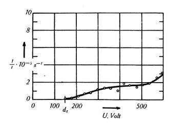
$\label{eq:Fig. 12.} \text{He, } Bariumkathode.$   $p=6.35 \text{ Tor, } d_z=0.35 \text{ cm.}$  Kein Photoumschlag.
