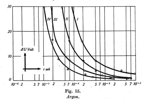
I: homogenes Feld, grosses Rohr, 2,35 Tor II: homogenes Feld, mittleres Rohr, 5,6 Tor III: homogenes Feld, kleines Rohr, Tor 14 IV: Anodenspitze, 14 Tor
