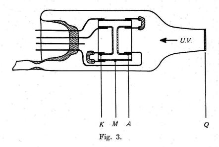
Elektroden, die von Rohr zu Rohr um den Faktor 2,5 variierten. Die Abstände von Anode und Kathode betrugen 1,3, 3,0 und 7,5 mm. Die Kathode K und die gelochte Anode A waren nach dem Rogowski-Profil<sup>17</sup>) abgerundet. Ein Schutzmantel M schützte die Entladungsstrecke vor Wandladungseinflüssen. Die Kathode wurde durch die Öffnungen der Anode und durch das Quarzfenster Q mit ultraviolettem Licht bestrahlt. Als Elektrodenmaterial wurde Nickel verwendet,
