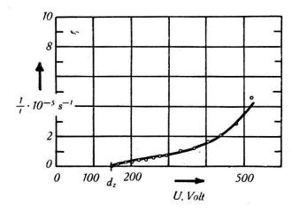
Fig. 10. Ne- Ar-Gemisch, 99% Ne, 1% Ar.  $p=7.1~{\rm Tor};~d_z=0.28~{\rm cm}.$  Kein eigentlicher Photoumschlag (Anstieg der Kurve wegen Raumwirkungen von M. A. und Licht?)
