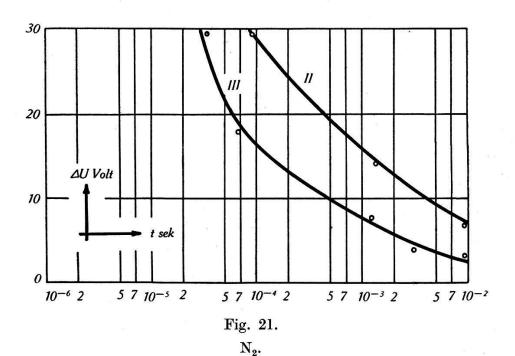
II: homogenes Feld, mittleres Rohr, 4,6 TorIII: homogenes Feld, kleines Rohr, 11,5 Tor
