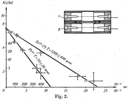
Anordnung der Zählrohre und Abfallkurven der Kernanregungszustände. Die Zahlen innerhalb des Koordinatensystems beziehen sich auf Pr<sup>141</sup>, diejenigen außerhalb auf Te<sup>124</sup>. Die vertikalen Striche bedeuten die statistischen Fehler der Meßpunkte, die horizontalen die Unsicherheit in der Verzögerungszeit des Verstärkers.
