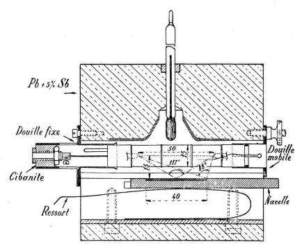
Fig. 1. Dispositif-compteur pour cendres radioactives.
