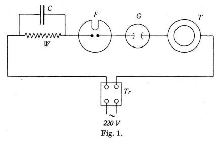
in dem Zeitintervall einer Wechselstromperiode Zählung statt, wo die Spannung oberhalb des Funkenpotentials liegt. Aber bei der Verwendung des Gerätes als Demonstrationsapparat spielt dies praktisch keine Rolle. Die Anordnung des neuen Funkenzählermodells reduziert sich daher auf die in Fig. 1 angegebene. Der Kleintransformator Tr 220/2200 V ist geschlossen über einen Widerstand  $W=5\cdot 10^5~\Omega$  mit parallelgeschaltetem Kondensator
