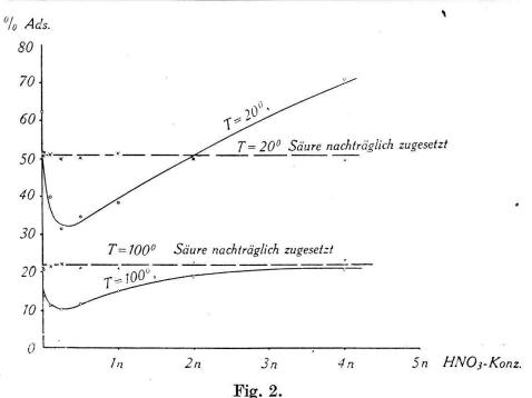
Adsorption von Cd\* an AgCl in Abhängigkeit von der  $\mathrm{HNO_3} ext{-}\mathrm{Konzentration}$ .
