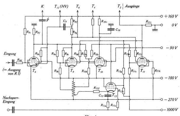
Fig. 4. Kombiniertes Relais II + III.
