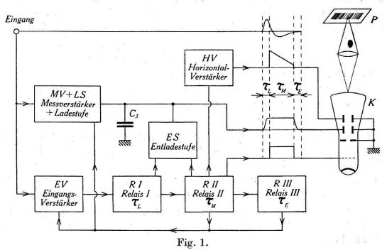
Blockschema des Impulsspektrographen.
