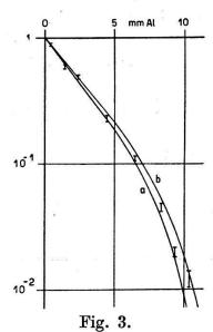
$\gamma$ -Strahlung von  $N^{16}$  (Absorption der Sekundärelektronen).
