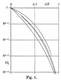
Absorptionskurven, bezogen auf gleiche Reichweite  $I/I_0 = f(d/R)$ . Reihenfolge von links nach rechts: RaE, UX<sub>2</sub>, P<sup>32</sup>, Cl<sub>1</sub><sup>38</sup>.
