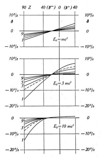
Fig. 7. Korrekturen für  $Z \neq 20$ .  $\delta = \frac{d_{n}{'}(Z) - d_{n}{'}(20)}{d_{n}{'}(20)} = f(Z)$  für  $E_{0}/mc^{2} = 1,3,10$ . Parameter: n = 1,(2),3,5,7,9.
