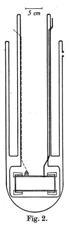
de une heure et quart. L'intérieur de la chambre de liquéfaction (chambre de diffusion comprise) était refroidi préalablement à l'azote liquide et ensuite évacué ce qui abaissait la température à environ 63° K.
