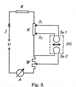
Schaltung zur Prüfung des Ohmschen Gesetzes.
