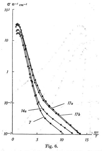
Temperaturabhängigkeit der Leitfähigkeit des SiC. (sehwarze Modifikation.)
