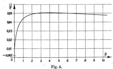
Endgeschwindigkeit der Rakete für verschiedene passive Massen.  $\delta \alpha = 2^0/_{00}$ . Die gezeichnete relativistische Kurve ist mit Ausnahme der nächsten Nähe des Nullpunktes von der klassisch gerechneten nicht zu unterscheiden.
