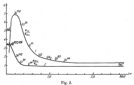
Verhältnis der Sensibilitäten von Blei- und Messingzählrohren (Kurve 1) und von Messing- und Aluminiumzählrohren (Kurve 2).
