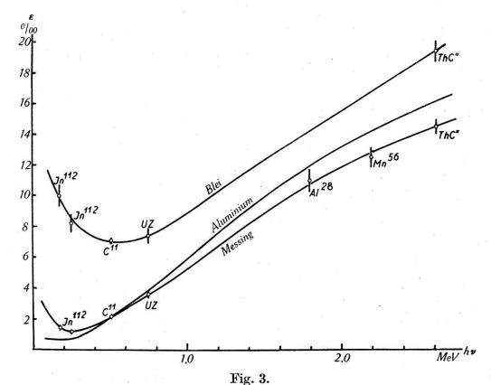
Empfindlichkeit von Zählrohren mit Blei-, Aluminium- und Messingkathode in Funktion der Quantenenergie.
