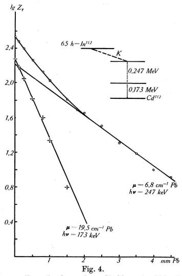
Absorptionskurve der  $\gamma$ -Strahlung des 65 h— $In^{112}$ .
