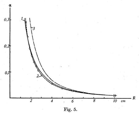
Wirksamer Raumwinkel eines  $\gamma$ -Zählrohrs mit Messingkathode in Funktion der Distanz Quelle—Zählrohrachse,  $\left(\alpha = \frac{\Omega}{4\pi}\right)$ .
