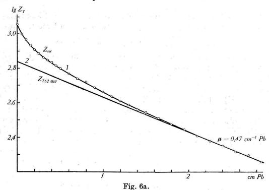
Absorption der y-Strahlung des Th (B+C+C") in Blei. Messung mit Bleizählrohr.
