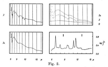
Oben: Kontinuierliche und punktweise Registrierungen der Absorption einer ca. 0,06 mm dicken Zyklohexan-Schicht.
