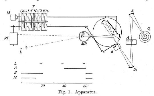
A: Absorptionstrog, B: Blende, L: Registrierlampe, M: Antriebsmotor, Q: Strahlungsquelle, MR: Radiomikrometer, RT: Registriertrommel,  $S_1$ — $S_3$ : Abbildungsspiegel, T: Steuertrommeln.
