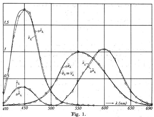
Vergleich der realisierten Darstellung  $_D\overline{x}_{\lambda}$ ,  $_D\overline{y}_{\lambda}$ ,  $_D\overline{z}_{\lambda}$ , mit den Normalreizkurven  $\overline{x}_{\lambda}$ ,  $\overline{y}_{\lambda}$ ,  $\overline{z}_{\lambda}$ .
