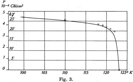
Temperaturverlauf der Polarisation nach Bantle und von Arx (ausgezogene Kurve). Winkeländerung  $\Delta \gamma$  zwischen den Ebenen (110) und (110) (Kreise).
