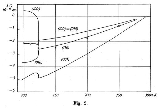
Temperaturabhängigkeit der Elementarabstände von  $KH_2PO_4$ . Kurven angeschlossen bei 293 an Werte von West.  $_0$  = Berechnete Punkte aus (100).
