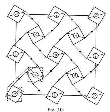
Struktur von  $KH_2PO_4$  bei Zimmertemperatur. Projektion parallel zur c-Richtung. Gestrichelt: Lage der  $PO_4$ -Tetraeder in  $YPO_4$ . Kreise mit Zahlen: P-Atome mit z-Koordinaten. Punkte: H-Atome.
