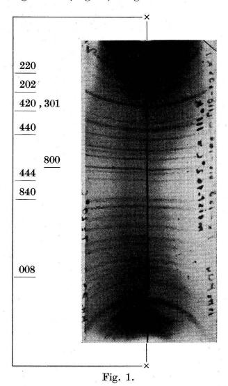
Debye-Scherrer-Aufnahme von  $\rm KH_2PO_4$ . Linke Bildhälfte bei Zimmertemperatur (293°), rechte Hälfte bei  $\rm T=110^{\circ}~K$ .
