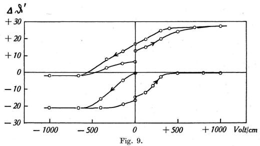
Verdrehung der Elementarbereiche gegen die Schnittfläche des Kristalls in Abhängigkeit von einem elektrischen Feld.
