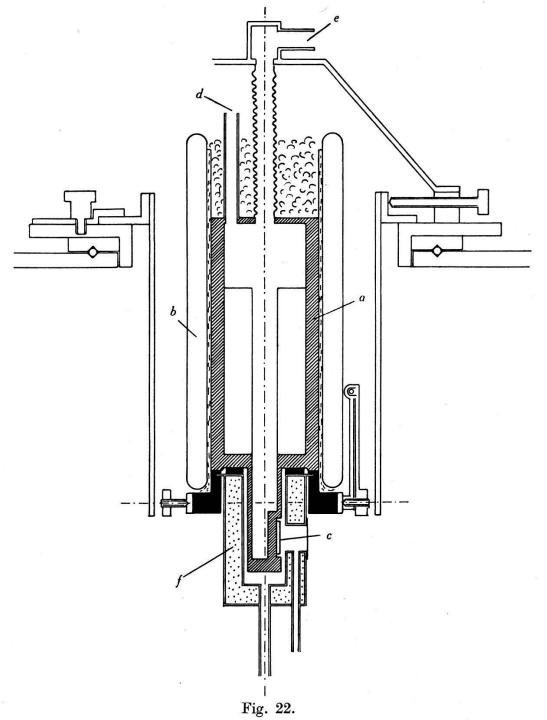
Schnitt durch den Kristallträger des Ionisationsspektrographen. (Masstab 1:2) a Kupferzylinder, b Dewar- oder Presstoffzylinder, c Kristall, d Einfüllstutzen für flüssige Luft, e Luftaustritt, f Doppelwandige Neusilberkammer.
