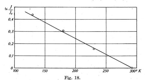
Temperaturverlauf der Reflexion (600) von NaCl. Gerade berechnet mit  $\Theta_{ch}=281^{\circ}$ .
