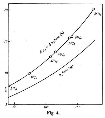
neben ist die aus Kohlrausch, Praktische Physik, entnommene Sättigungskurve eingezeichnet. Man erkennt, dass die Kurven durchaus parallel verlaufen. Auch das Verhältnis der Werte Manometerdruck in mm Öl: Sättigungsdruck in mm Hg erweist sich als ungefähr gleichbleibend zu 1,29—1,34. Der Vollständigkeit halber sind noch die relativen Feuchtigkeiten für die einzelnen Messpunkte angegeben.
