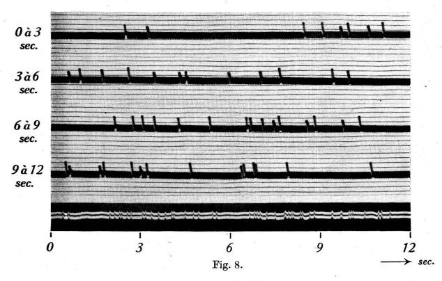
sente l'enregistrement obtenu pendant le même intervalle de temps que pour les lignes 1 à 4. On peut constater qu'il y a concordance entre les deux résultats. Toutefois, pour des intervalles de temps trop petits, les déplacements du jet ne sont plus séparés (voir par exemple entre la 9<sup>me</sup> et la 12<sup>me</sup> seconde). L'oscillographe cathodique possède donc un pouvoir de résolution plus grand.
