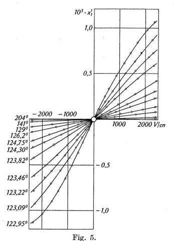
Deformation in Funktion des elektr. Feldes. Parameter: abs. Temperatur.
