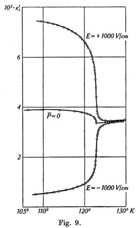
Deformation in Funktion der Temperatur. Parameter: elektr. Feld.
