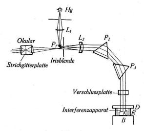
Fig. 1. Schema der optischen Versuchsanordnung.
