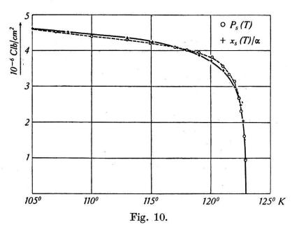
Sättigungsdeformation und spontane Polarisation in Funktion der abs. Temperatur.
